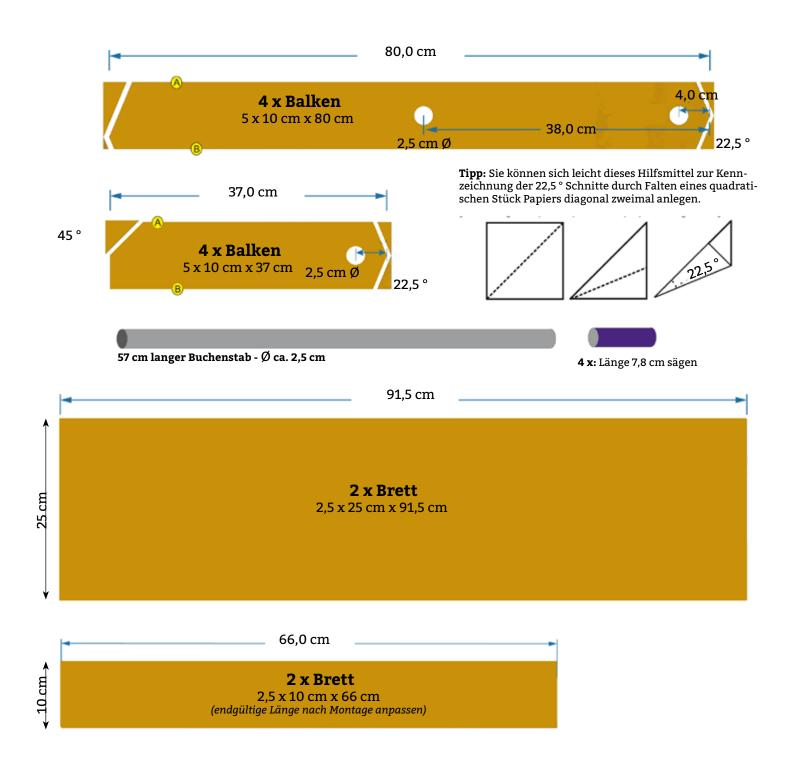
Alle Teile vor dem Zusammenbau sorgfältig mit der Hand schleifen (von grob nach fein) und an den Ecken und Kanten abrunden. So erhält die Werkbank später eine wunderbare glatte Oberfläche.
